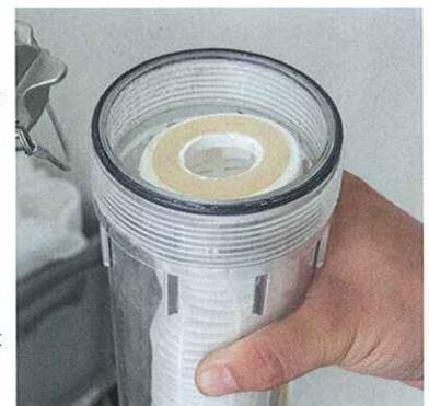
**i** Der Filtereinsatz ist ein Verschleißteil und sollte regelmäßig ersetzt werden.
