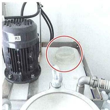
Nach der Reinigung kann das Wasser im Abwasseraufbereitungstank abgelassen werden.
